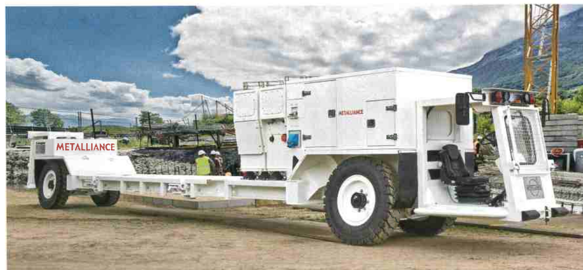
Engin d'approvisionnement Metalliance d'un tunnelier sur batteries électriques.
