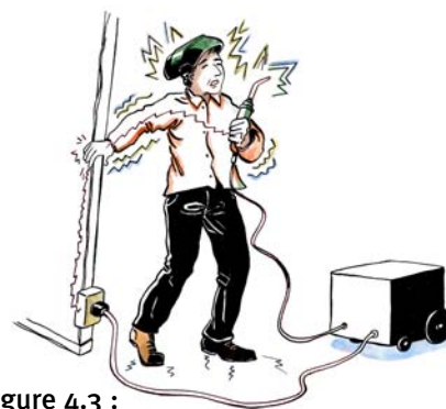
Figure 4.2 : Contact direct : le courant passe par l'électrode et revient par la pince de retour en passant par le sol humide
